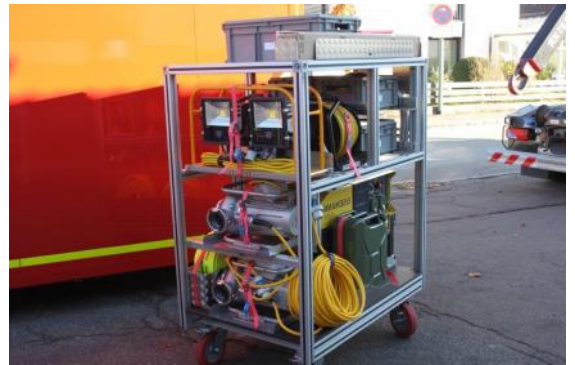
RC Stromerzeuger + Pumpen, Beleuchtung
